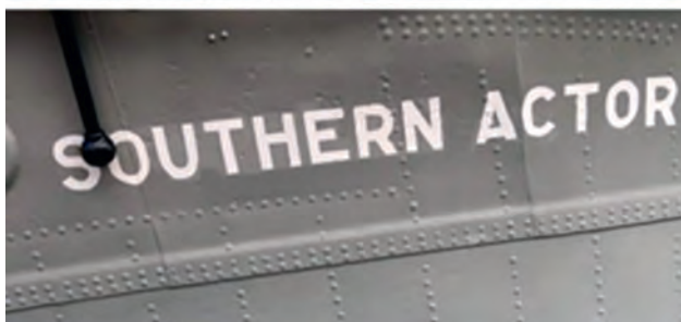
Hvalbåten "Southern Actor" bygd ved Smiths Docks Ltd, Middlesbrough, England i 1950. Klinking av skrogplater til hverandre og klinking av skrogplater mot spant. (Et par sveisesømmer er også synlige.) Foto: Skagerak Dampskibsselskap A/S og Knut Brautaset.
